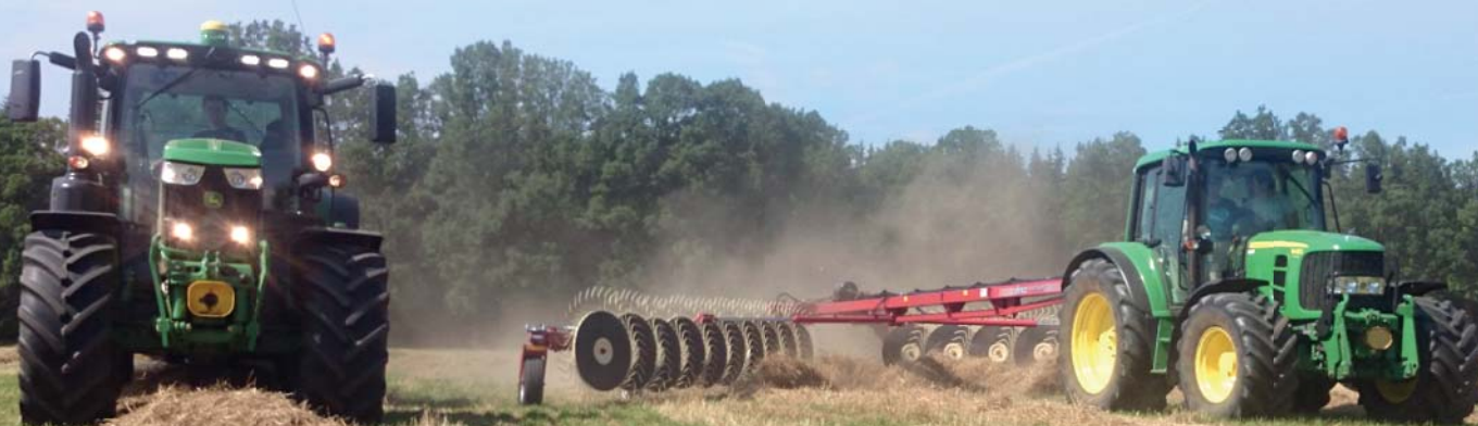
► Při práci má shrnovač pracovní záběr 11,4 m a možnost regulace šířky řádku
