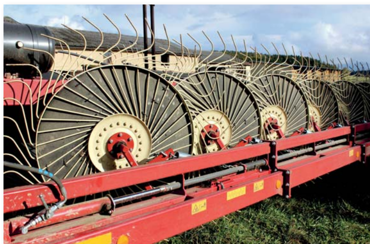
► Shrnovač Sitrex Magnum MKE 20 je vybaven ocelovými koly s plastovými výplněmi a 40 ocelovými prsty
